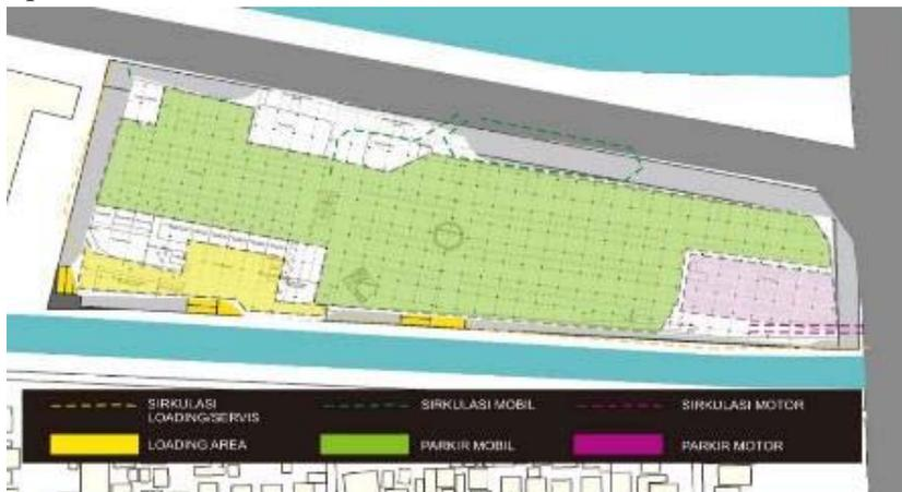
Gambar 8. Penempatan parkir mobil, motor dan kendaraan servis
